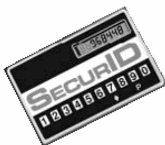
図 3.14 ワンタイムパスワード生成装置の例
